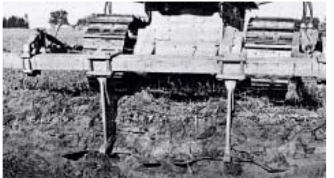
شكل 4. استخدام محراث القص التحتي لتكسير الطبقة المرصوصة.
