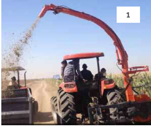
قطع المحصول وهو أخضر ( في طور اللبنة ) بواسطة القاطعة Chopper
