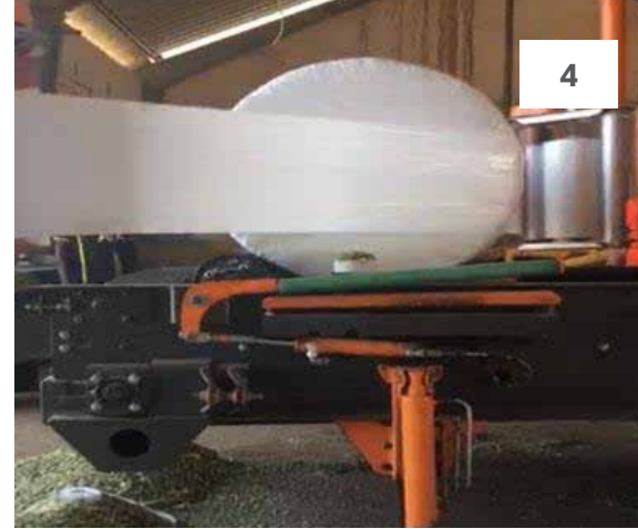
تغليف المحصول بالبلاستيك وهي المرحلة الأخيرة من تصنيع ( السيلاج )
